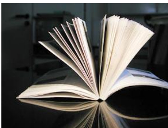
Samozavírací efekt knihy lepené tradiční technologií (Hot melt nebo PUR – polyuretanová lepidla)
