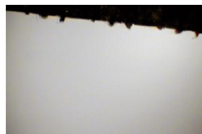
Vzhled okrajů papírů v místě lepení při tradiční výrobě
