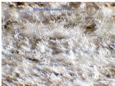
Vzhled hřbetu knižního bloku v místě lepení při dokonalém obnažení vláken papíru
